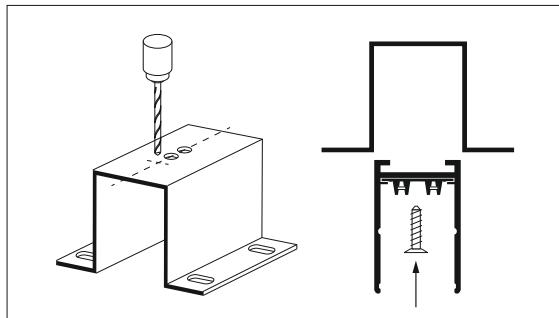
1. Сделайте разметку на шинопроводе с учетом установки скоб через каждые 30см. Для монтажа необходимо приобрести саморезы по металлу размером примерно 3х20мм;
