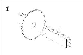
Нарежьте трек согласно проектным размерам. Резка допускается в любом месте под углом в 90 градусов;
