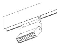
**ВНИМАНИЕ!!!** Подключение осуществляется при выключенной электрической сети. Установите подключенный ввод питания в шинопровод. Нажмите на кнопку и вставьте в адаптер до щелчка;
