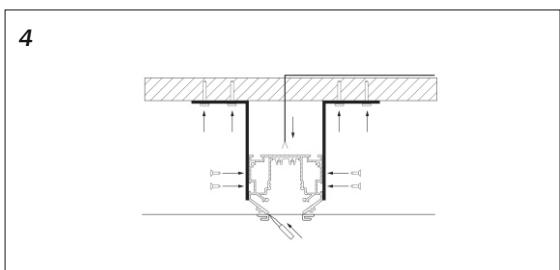
Закрепите шинопровод на поверхности потолка с помощью монтажных уголков и саморезов. Натяните полотно потолка и проклейте края гарпунов по всей длине шинопровода;
