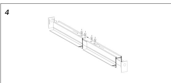
Соедините отрезки шинопровода с помощью коннекторов и установите заглушки. Установите защитный экран сразу после монтажа, это защитит его от деформации и дополнительно от пыли во время остальных монтажных работ;
