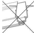
Не допускайте деформации шинопровода во время транспортировки и монтажа;
