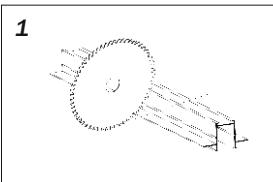
Нарежьте шинопровод согласно проектным размерам, предварительно сняв токоведущие дорожки. Резка допускается в любом месте под любым углом. Резка шинопровода осуществляется торцовочной пилой;
