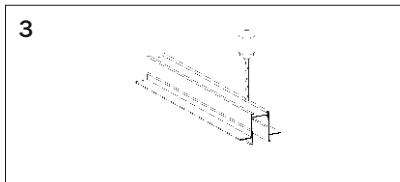
Просверлите отверстия для ввода кабеля питания и снимите фаски;
