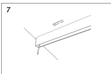
Приложите шинопровод, вплотную к стене и поверните рычаги на фиксаторах.
