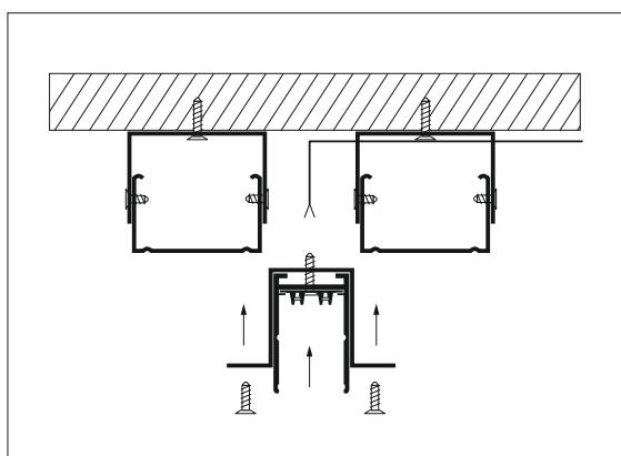
5. Ведите питающий провод в шинопровод. Установите шинопровод в монтажный паз и закрепите саморезами;
