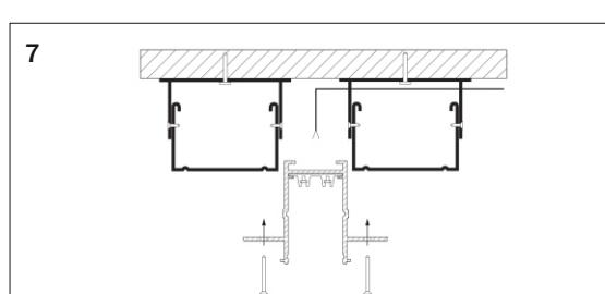
Установите шинопровод в монтажный паз и закрепите саморезами;
