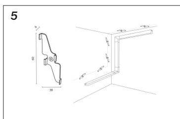
Закрепите на стене фиксаторы для накладного шинопровода с интервалом 50 см;
