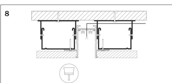
Установите гипсокартон вплотную к стенкам шинопровода и закрепите саморезами. Приклейте слой стеклотканевой сетки. Покройте гипсокартон шпатлевкой в один уровень со стенками шинопровода.
