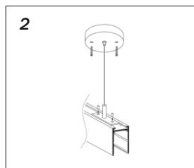
Установите подвесы в паз на тыльной части шинопровода;
