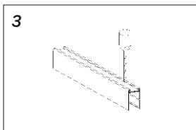
Просверлите отверстия для ввода кабеля питания и снимите фаски;
