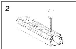
Просверлите монтажные отверстия и отверстия для ввода провода питания;
