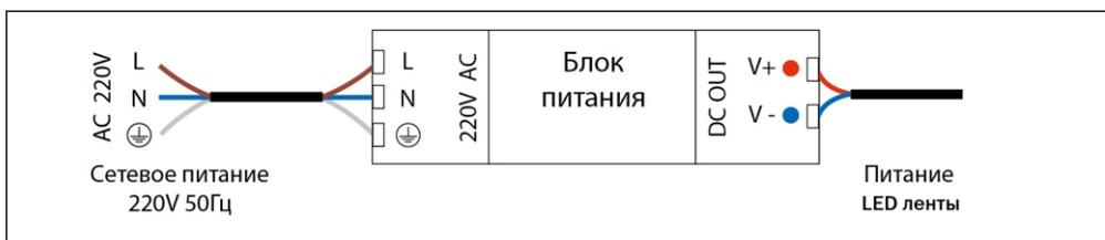
2. Подключите блок питания согласно обозначениям на нём к кабелю сетевого питания 220В;
